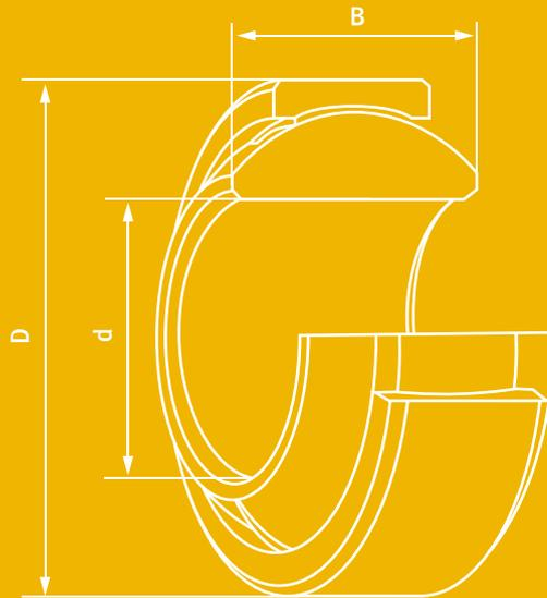
Radial-Gelenklager, Stahl / Stahl, mit breiterem Innenring
