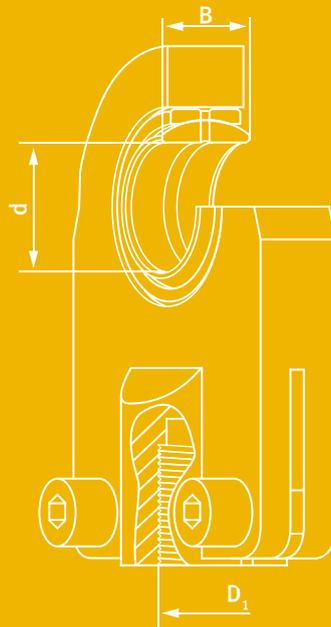
Hydraulischer Gelenkkopf, Stahl / Stahl mit Innengewinde
