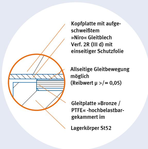
Alle Stahlteile sind galvanisch verzinkt oder mit Rostschutzanstrich!
